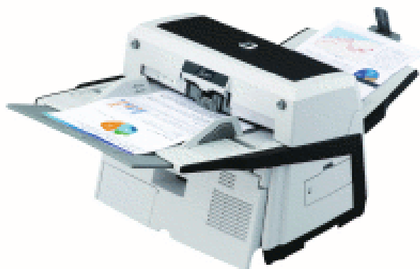
Ilustracja 9. Skaner szczelinowy: Fujitsu fi-6670 Color Duplex Document Scanner, [dostęp: 4.11.2012], http://www.fujitsu.com/us/services/computing/peripherals/scanners/production/fi-6670.html .
