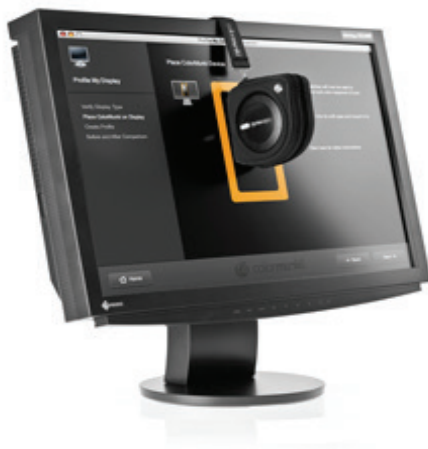
Ilustracja 15. Kalibrator ColorMunki Photo w trakcie przeprowadzania kalibracji monitora, [dostęp: 20.11.2012], http://xritephoto.com/images/products/CMUNPH_M2.jpg .
