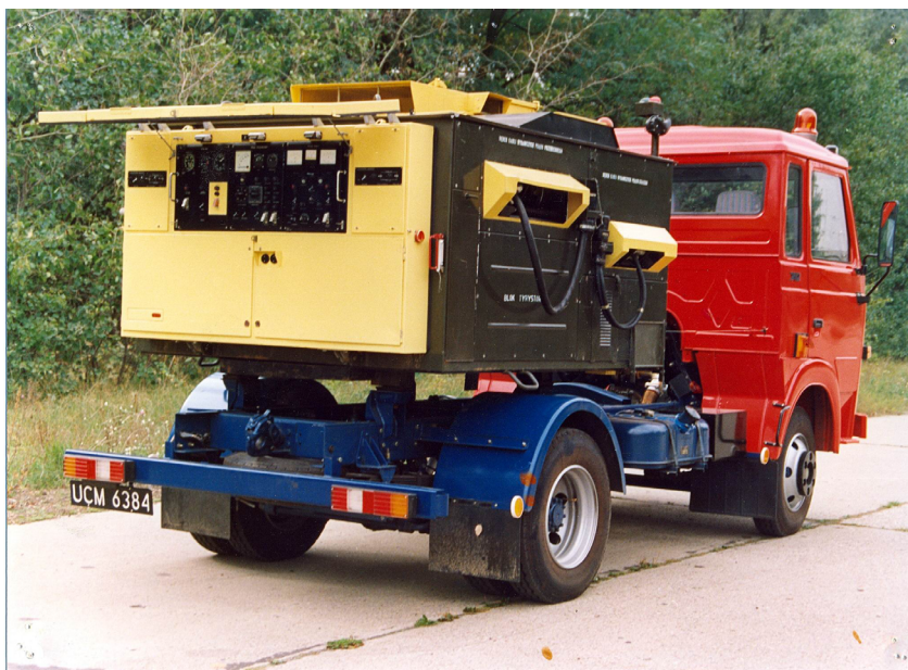
Rys. 35. LUZES V z generatorem napędzonym silnikiem turbinowym
