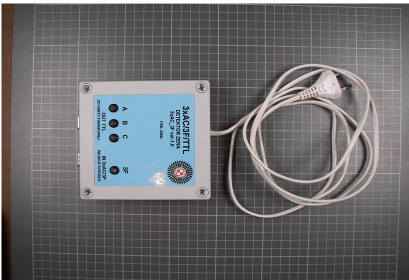
Rys. 24. Przystawka pomiarowa AC trójfazowa
