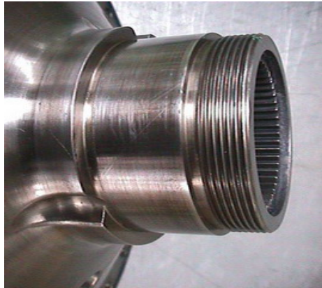
Rys. 84. Czop łożyska środkowego, miejsce połączenia obu części wału (wał turbiny, wał sprzężarki)
